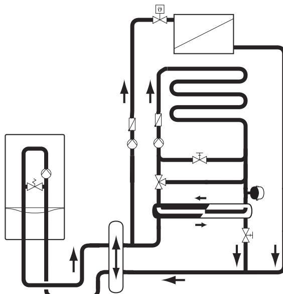
Принципиальная схема: 2-контура отопления.
