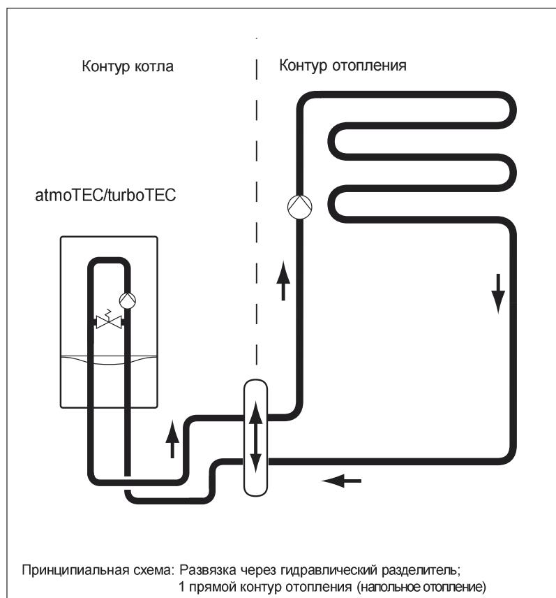
Принципиальная схема: Развязка через гидравлический разделитель;
