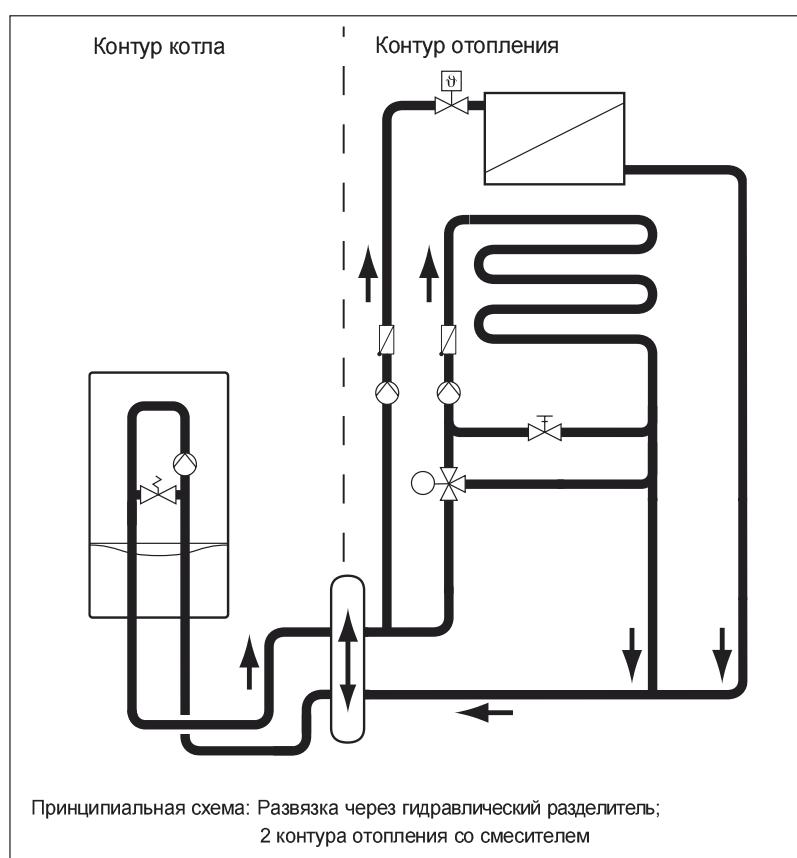
Принципиальная схема: Развязка через гидравлический разделитель;
