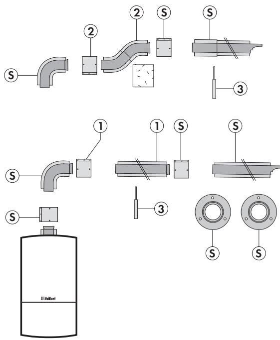
S Базовый комплект для горизонтального прохода через крышу 80/125, алюминий/сталь
