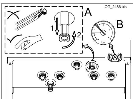
**!** Котел оборудован дифференциальным гидравлическим реле давления, которое отключает котел в случае блокировки насоса или при недостатке воды.
