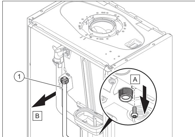
3. Снимите газовую трубу (1).
