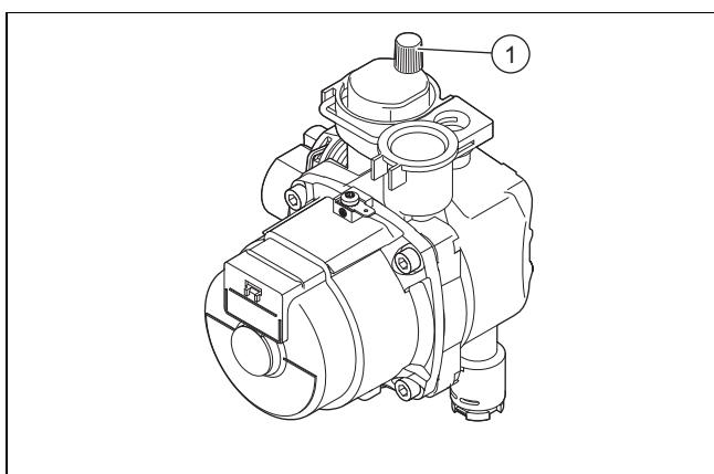
1. Снимите колпачок вентиля для выпуска воздуха (1) на насосе, а также на быстroredействующих воздухоотводчиках.
