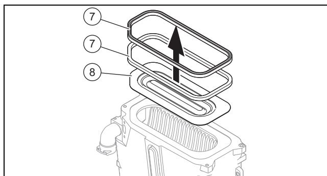
10. Снимите уплотнения для горелки (7) и горелку (8).
