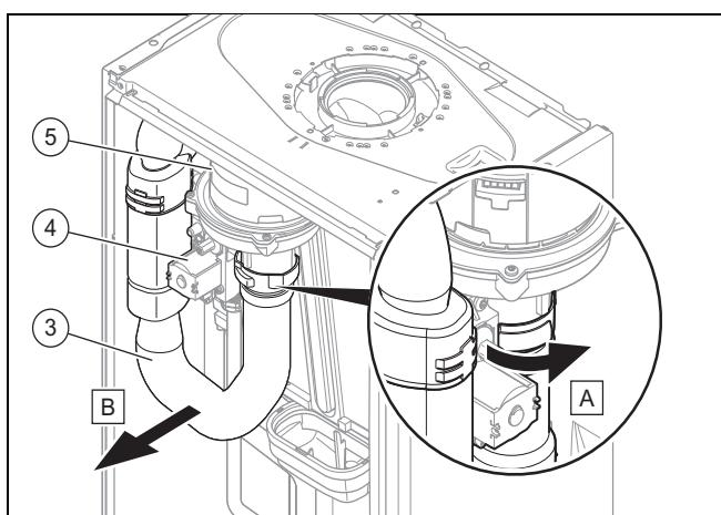
7. Снимите воздухозаборную трубу (3).
