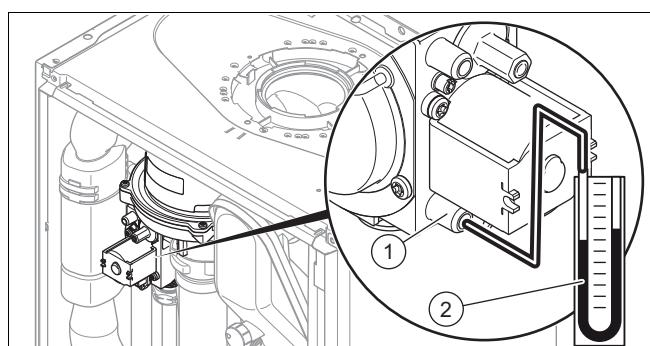
3. Подключите манометр (2) к измерительному штуцеру (1).
