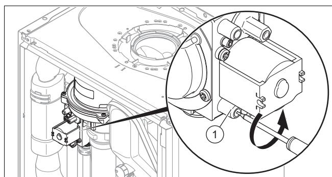
2. С помощью отвертки выкрутите уплотнительный винт на ниппеле для проведения измерений (1) газовой арматуры.
