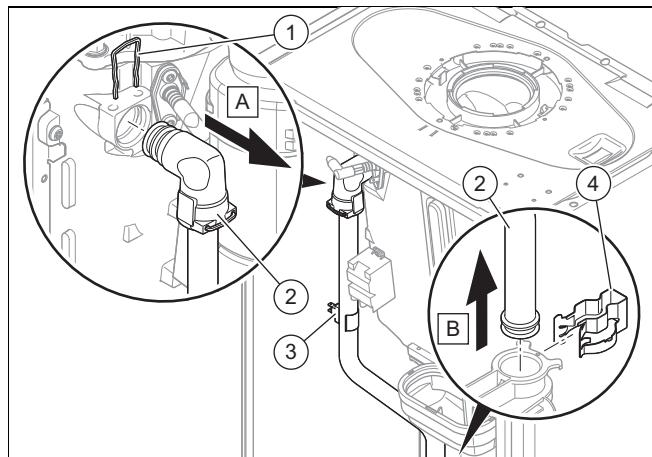
4. Снимите датчик температуры (3).
