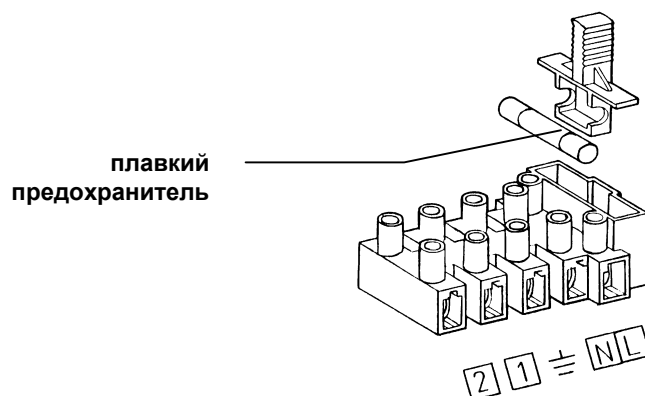
Рис. 7: Клеммная колодка электропитания
